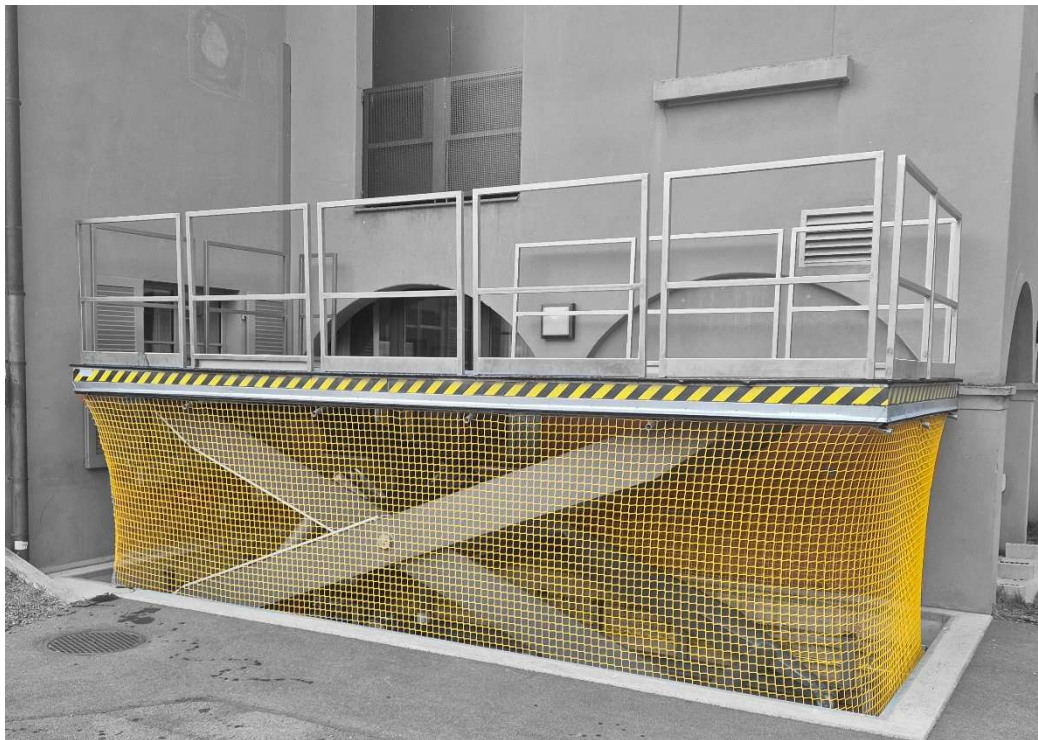
Masse: 6.0m x 2.70m Max. Nutzlast: 3t
